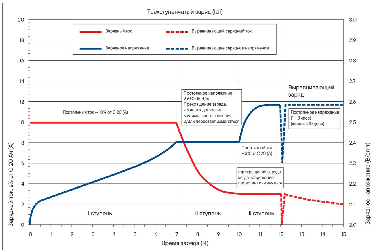
Схема 2: Рекомендуемый график заряда аккумуляторных батарей с жидким электролитом IU
