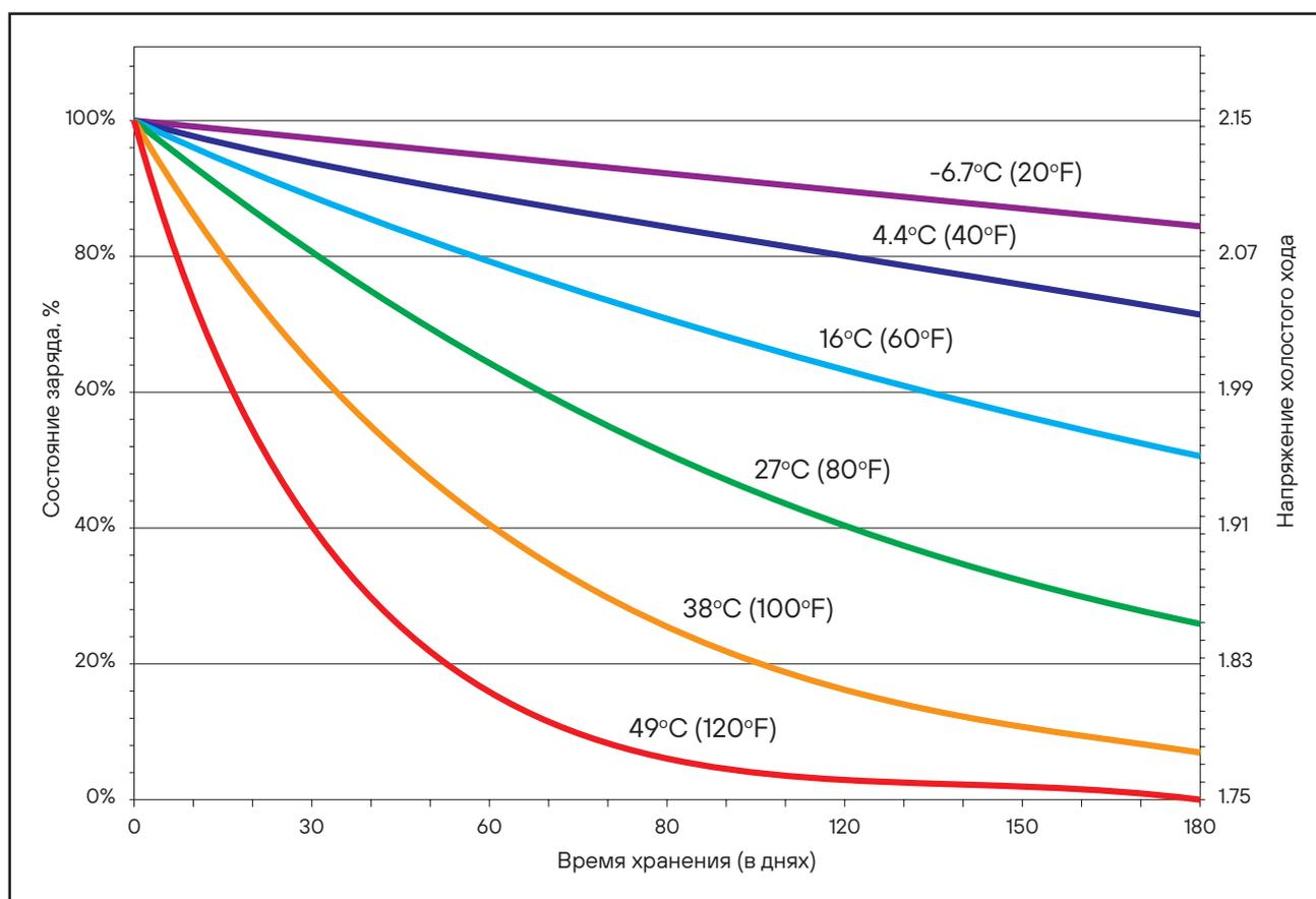
Схема 4: Саморазряд свинцово-кислотного аккумулятора при температуре от  $-7^{\circ}\text{C}$  до  $49^{\circ}\text{C}$
