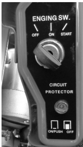
Рис.7 Замок зажигания и предохранитель
