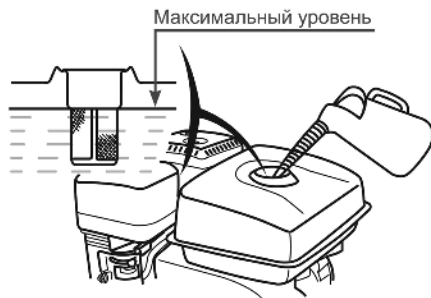
Рис. 5 Максимальный уровень топлива в топливном баке
