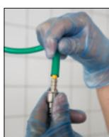
4. Montieren Sie den Ansaug-schlauch.
