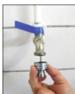
1. Montieren Sie den Hahnanschluß (0700) an den Wasserhahn.
