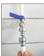
2. Vissez le tuyau avec le raccord rapide 1/2" (article n° 0701) sur le robinet d'eau.
