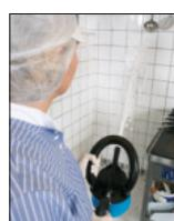
9. Расстояние от соплового отверстия инжектора до очищаемой поверхности должно составлять не менее 0,5 метра.
