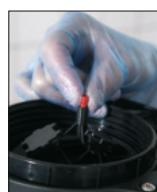
3. Установите в инжектор (распылительную головку) подходящий штуцер (инструкцию по выбору штуцера см. на следующей странице).
