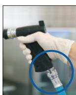
7. Le tuyau avec raccord rapide 1/2" (article n° 0701) est raccordé à l'embout du pistolet à eau.
