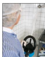
9. La distance entre l'embout des buses de l'injecteur et la surface à nettoyer doit d'être de 50cm minimum.
