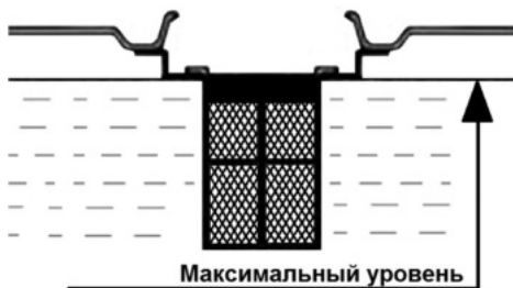
Рис. 8 Максимальный уровень топлива в топливном баке
