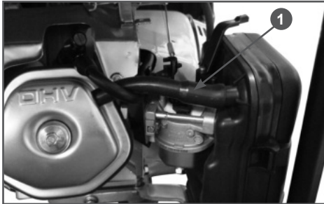
Рис. 12 Трубка системы вентиляции картера
