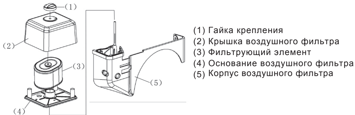
Рис. 6. Очистка / замена фильтрующего элемента
