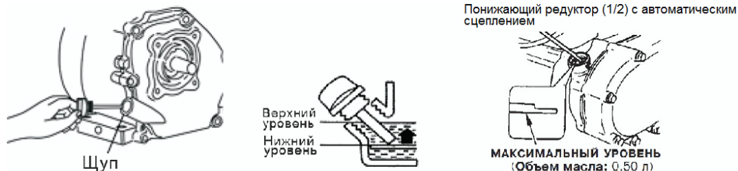
Рис. 3. Проверка уровня масла в двигателе и редукторе
